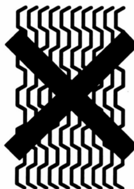
Рисунок В.6 – Вид пакета пластин при неправильной сборке
