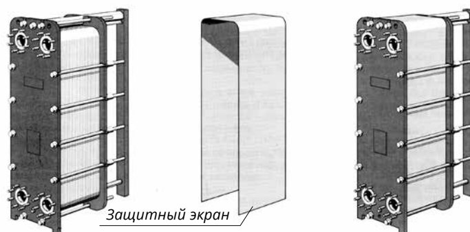
Рисунок А.6 – Схема установки защитного экрана
